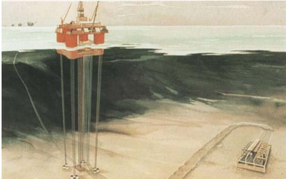
Figura 1. Plataforma tipo “ Tension Leg ”. Observa-se a estrutura dos componentes cilíndricos, tais como os risers que levam a produção do poço petrolífero para a superfície (Nishimoto, 1997).
